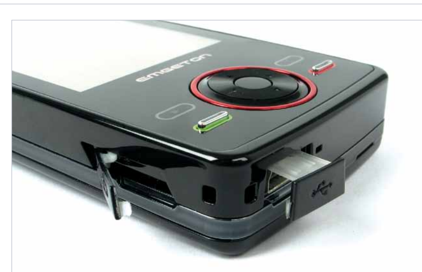
▲ Pod krytkami najdete microSDHC slot (až 32 GB) a miniUSB, 3,5mm jack nikoliv
